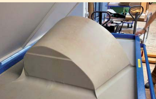
Um der Rückenlehne die endgültige Freiform zu geben, wurde eine positive Form aus MDF mit der CNC erstellt, auf der dann die drei Lagen der Rückenlehne in der Vakuumpresse in Form verleimt werden konnten (links). Der für die Verbindung zur Sitzfläche nötige Falz wird an einer eigens entwickelten Vorrichtung ebenfalls auf der CNC gefräst (Mitte), erst dann können Sitzfläche und Rückenlehne auf einer speziellen Verleimvorrichtung verbunden werden.
