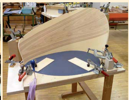
Um der Rückenlehne die endgültige Freiform zu geben, wurde eine positive Form aus MDF mit der CNC erstellt, auf der dann die drei Lagen der Rückenlehne in der Vakuumpresse in Form verleimt werden konnten (links). Der für die Verbindung zur Sitzfläche nötige Falz wird an einer eigens entwickelten Vorrichtung ebenfalls auf der CNC gefräst (Mitte), erst dann können Sitzfläche und Rückenlehne auf einer speziellen Verleimvorrichtung verbunden werden.
