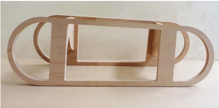
Mittels CNC-Technik wird der einheitliche Rahmen gefertigt (oben), die Gestaltung der Seitenflächen ist hingegen bei jedem Schüler individuell (rechts).
