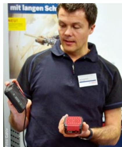
Beim induktiven Laden kann der Akku am Gerät verbleiben, geladen wird einfach durch Abstellen auf dem entsprechenden Induktionsfeld, beispielsweise schon bei kurzen Arbeitsunterbrechungen, erklärt Jan Breitenbach.
