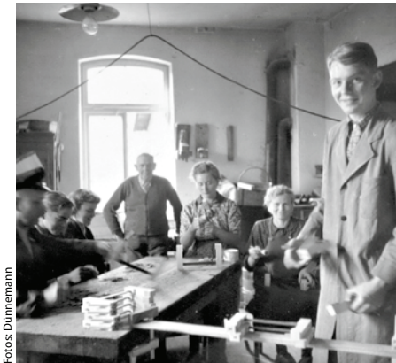
1954 wurden die Korkplättchen von Familienmitgliedern mit Knochenleim an die Klemmzwingen geklebt (links). Später konnten viele der Bearbeitungsschritte automatisiert werden: die heutige Fertigungsstraße (Mitte) und Endmontage mit Qualitätskontrolle (rechts)
