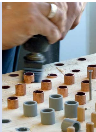
Mit dem richtigen Sägeblatt geht der Multicutter auch durch Metall; Bimetall-TiN-Beschichtungen und Diamantzähne sind besonders langlebig.
