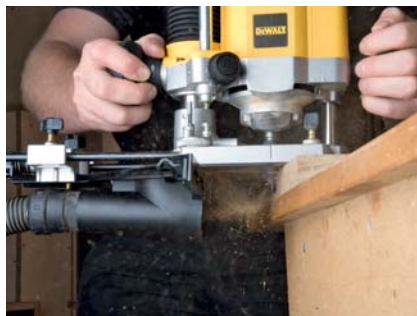
Kompakt, leichtgewichtig und vielseitig ist die neue Multifunktionsfräse „D 26204 K“. Sie kann als Tauch- sowie als vollwertige Kantenfräse eingesetzt werden.
