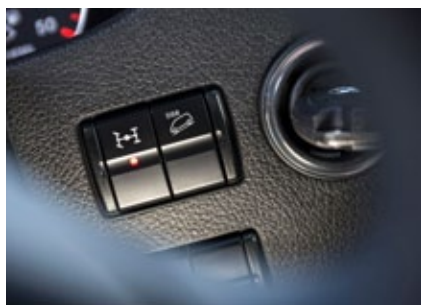
Um Kraftstoff zu sparen, wird der Allradantrieb nur bei Bedarf aktiviert.
