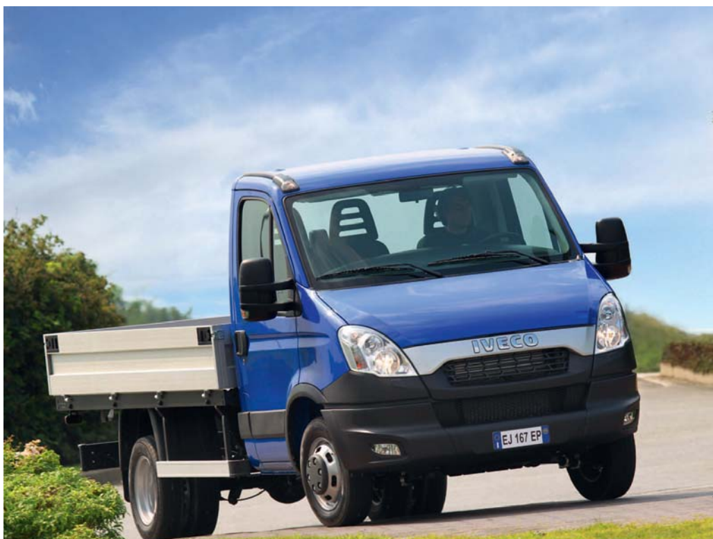
Beim neuen „Daily“ ist der Kühlergrill in den Frontbereich integriert; die neuen Scheinwerfer mit eingebauter Tageslichtfunktion (DRL) und Fog Cornering-Nebelleuchten. Letztere folgen bis zu einem Tempo von 40 km/h dem Lenkradius.
