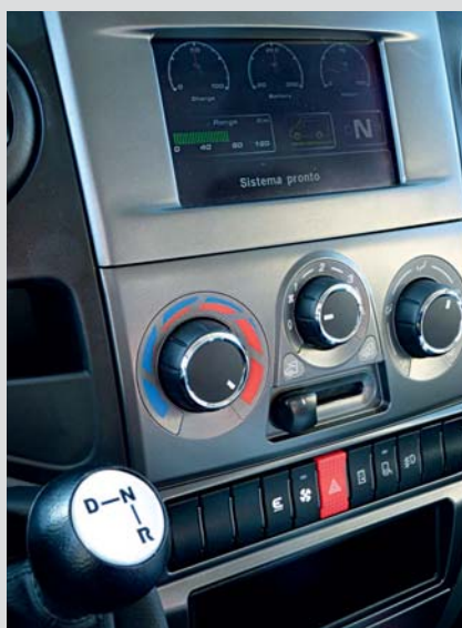
Ungewohntes Cockpit: Fahrerinformationsdisplay im „Daily Electric“ mit Anzeigen für Batterieladezustand, -temperatur, -spannung, Stromfluss und Wahlhebelposition mit den drei Fahrfunktionen.
